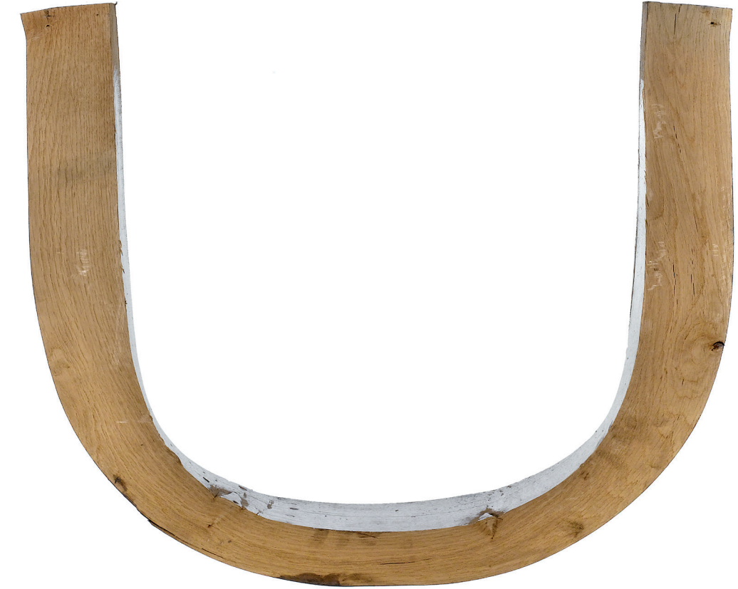
Gebogenes Holzstück, nach 3 Wochen in der Trockenkammer bei 85° C, 11,6 kg
